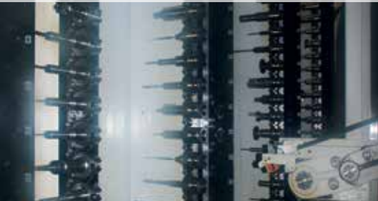
Bei 320 Werkzeugen im Maschinenmagazin hilft die Werkzeugverwaltung ToolDIRECTOR den Mitarbeitern, den Überblick zu behalten. Auch die Bevorratung und Beschaffung hat sich dadurch deutlich verbessert.
