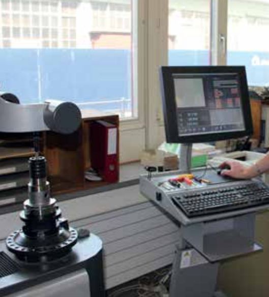
Bei 320 Werkzeugen im Maschinenmagazin hilft die Werkzeugverwaltung ToolDIRECTOR den Mitarbeitern, den Überblick zu behalten. Auch die Bevorratung und Beschaffung hat sich dadurch deutlich verbessert.
