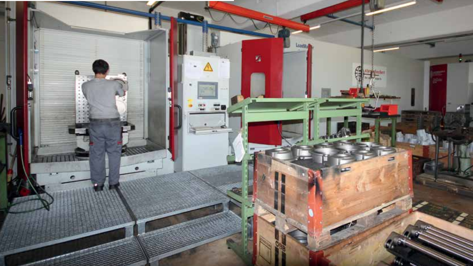
High-End-Maschinen – unter anderem ein neues Starrag Heckert 4-Achs-Bearbeitungszentrum mit Palettenwechsel-System mit Bahnhof - bieten dem Lohnfertiger höchste Präzision und größtmögliche Flexibilität bei der Bearbeitung.
