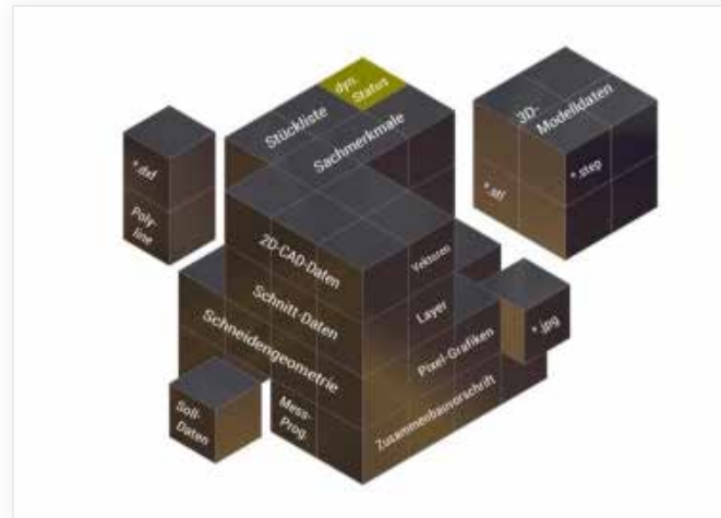
TCI-Werkzeugdatencontainer: Der Werkzeugdatencontainer hält sämtliche Werkzeuginformationen vor. Mit der TCI-Technologie können die notwendigen Informationen bedarfsgerecht vom Zielsystem abgegriffen werden.
